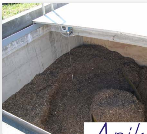
Il sistema di controllo programmabile (PLC) ed il sensore per la misura del livello di liquidi e solidi
